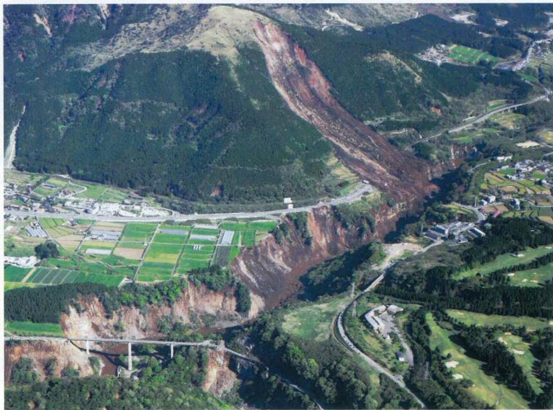
阿蘇大橋付近で発生した大規模な斜面崩壊
